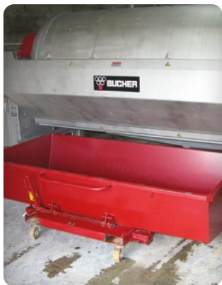
benne basculante GS-V standard ou sur-mesure pour récupération du marc
